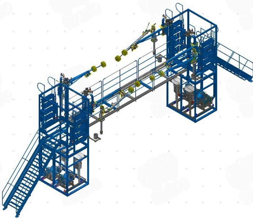
Комплекс автоналива — это конструктивно объединённый в единый модуль комплект оборудования для автоматизированного дозированного налива нефтепродуктов в автомобильные цистерны.
