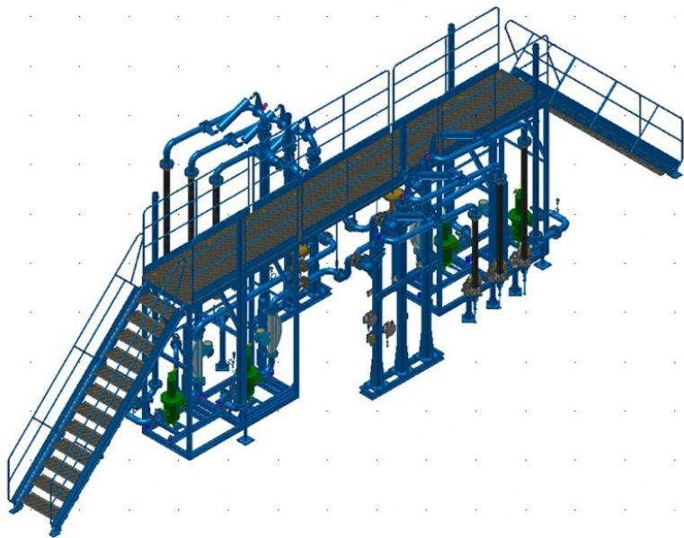
Комплекс нижнего налива для одновременного налива 4-х различных продуктов и отвода паров по схеме «4+1»
