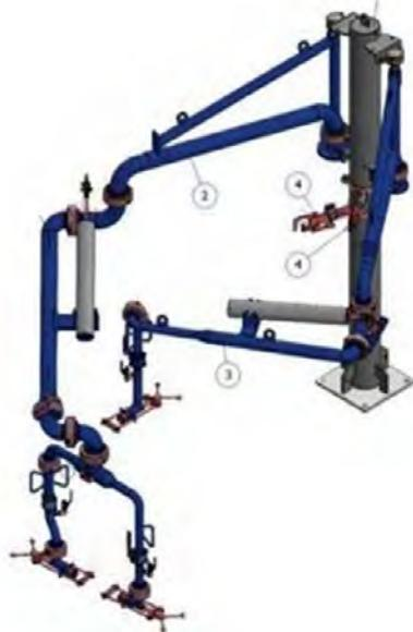
Комплекс для слива-налива сжиженных углеводородных газов в железнодорожные цистерны представляет собой единый модуль, предназначенный для проведения сливно-наливных операций СУГ в железнодорожные цистерны на объектах хранения и переработки.
